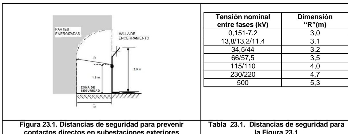
**Figura 23.1. Distancias de seguridad para prevenir contactos directos en subestaciones exteriores**
