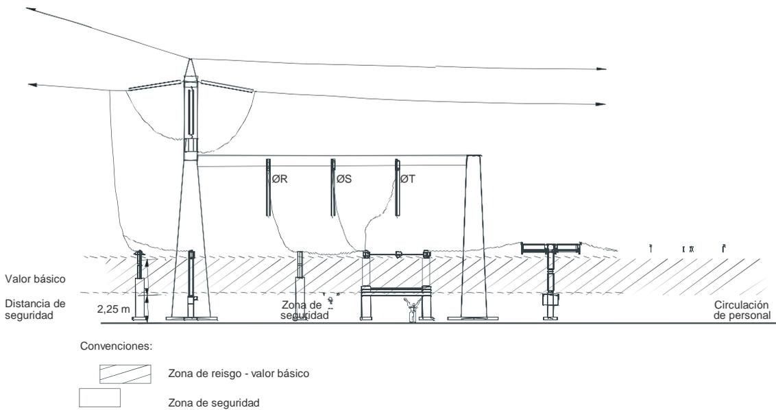
Figura 23.2 Zona de seguridad para circulación de personal
