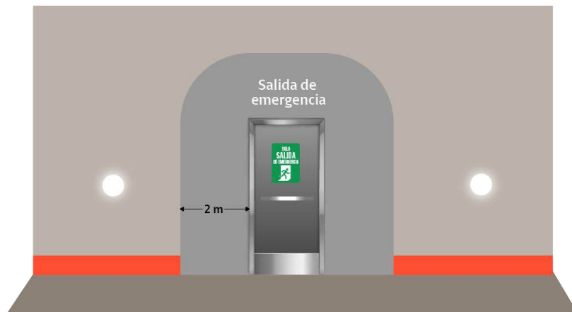
Figura 3.5.5.4.3 a. Iluminación de la salida de emergencia en túneles (Adaptada de CIE 193).
