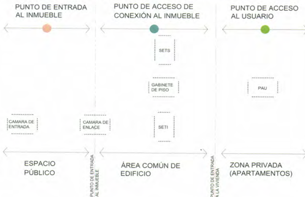
Gráfica 1. Esquema general de una red interna de telecomunicaciones
